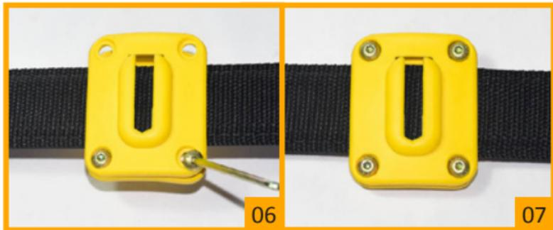
Coloque o cinto entre elas, prenda os dois **parafusos inferiores** da alça (foto 06), deslize-a pelo cinto até a posição que quer que seu porta carregador fique posicionado e prenda os outros dois parafusos superiores para fixar a alça no cinto (foto 07).
