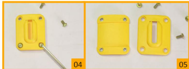
Em seguida, solte os quatro **parafusos da alça** utilizando a **chave Allen de 3 mm (ref.: pág. 05, foto 00, item 6)** (foto 04). A alça ficará em duas partes (foto 05).
