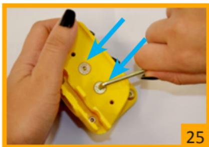
O porta carregador vem ajustado para o uso destro. Para inverter o porta carregador para canhoto, com os lados já separados, pegue a lateral fêmea e solte completamente os parafusos que prendem o conjunto da rótula indicados na foto 25.
