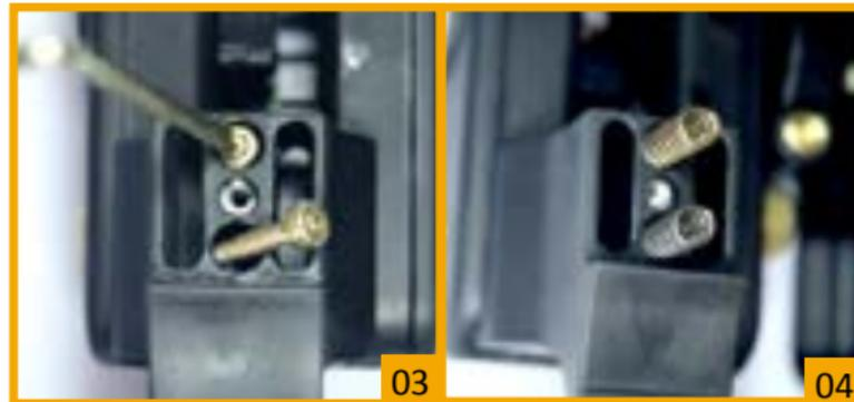
Com a haste encaixada, coloque 2 parafusos M3x12 nos furos no topo da haste como na foto acima.
