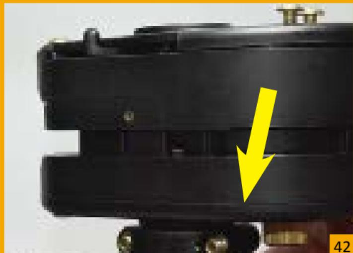
Com os lados encaixados, use as duas mãos para pressionar e juntá-los até ficarem completamente encostados.
