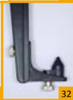
Apoie o cano no ponteiro e baixe o revólver para que apoie o guarda-mato na parte inferior do lado A (foto 33). Se não for possível encaixar o guarda-mato na trava que você acabou de ajustar, modifique a altura do suporte L em relação à haste até que consiga.
