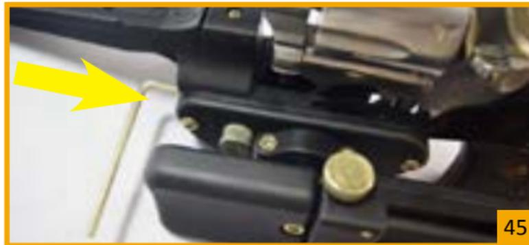
Com a arma no coldre e a trava passiva ativada, use a chave Allen (foto 45) para subir ou descer a caixa da trava ativa enquanto olha o movimento da trava pela abertura frontal do coldre. Quanto mais inserida no guarda-mato melhor.
