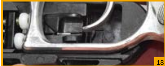
Acima temos a vista frontal da trava “L” mostrando sua largura mínima (testes devem ser feitos com a arma inserida).
