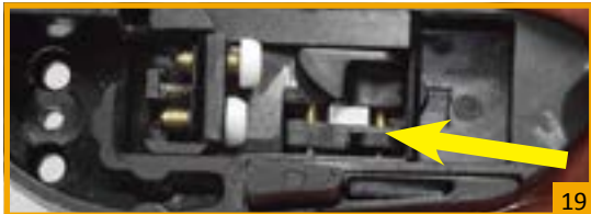
Acima a vista frontal da trava “L” mostrando sua largura aumentada.
